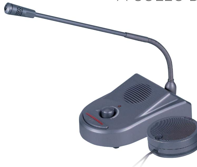
Consigliato per sportelli, reception, ticket, ecc. Composto da microfono da tavolo a collo di cigno 300mm staccabile con attacco XLR e da un altoparlante separato con microfono e tasto di chiamata. Capsula electret, a cardioide. Altoparlante con cavo 3 metri. Regolazione volume.
